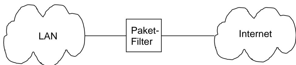
Statische Paketfilter dieser Art werden häufig durch Router realisiert.
