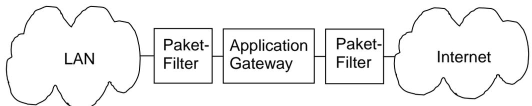
Ein Dual Homed Gateway besteht aus dem Application Gateway, das auf einem mit zwei Netzwerkanschlüssen ausgestatteten Computer installiert ist und das durch einen oder, wie in der Abbildung dargestellt, durch zwei Paketfilter flankiert wird. Der Gateway-Computer muss dabei so konfiguriert sein, dass kein Datenpaket unverändert in das interne Netz gelangen kann. Dies lässt sich durch Abschalten des IP-Forwardings realisieren.
