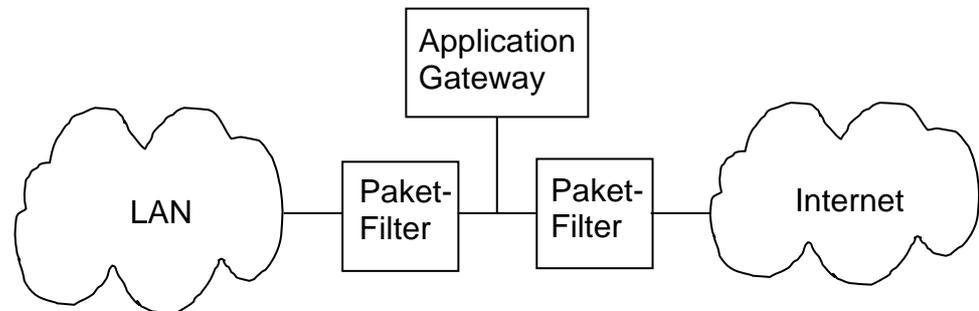
Die Filterregeln der Paketfilter müssen dabei so gewählt werden, dass die zwischen LAN und Internet ausgetauschten Datenpakete stets über den Gateway-Rechner geleitet werden.
